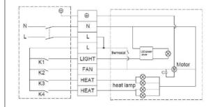
TERMINAL BLOCK 220-240V a.c 50Hz
